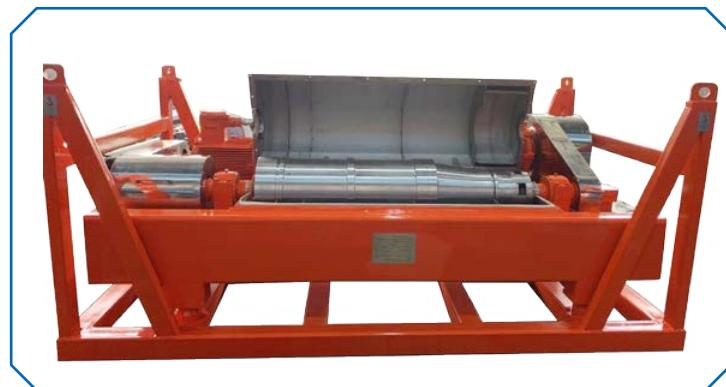
1. Максимальная мощность среди аналогичных моделей отрасли, мощность главного двигателя – 37кВт., мощность вспомогательного двигателя – 11кВт.
